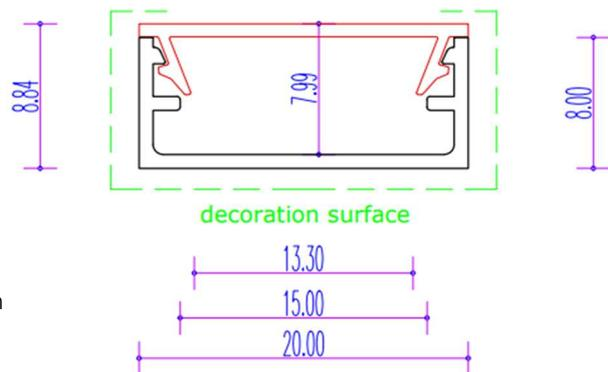
Materialzusammensetzung von 6063-T5 Aluminium Legierung | pulverbeschichtet | recyceltes Aluminium
